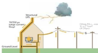
Figura 3: Ilustración de la corriente de sobretensión que fluye desde un rayo que golpea directamente a la estructura (Fuente S1)
