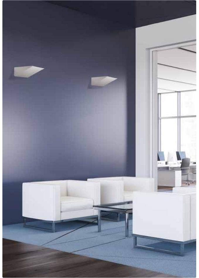
Applique professionnelle à éclairage indirect. L'émission asymétrique permet un éclairage indirect en profondeur pour tous les espaces. Utilisée seule, elle offre un éclairage tamisé et confortable tandis que, combinée avec un éclairage direct, elle équilibre les luminances et optimise le confort visuel dans l'espace.
