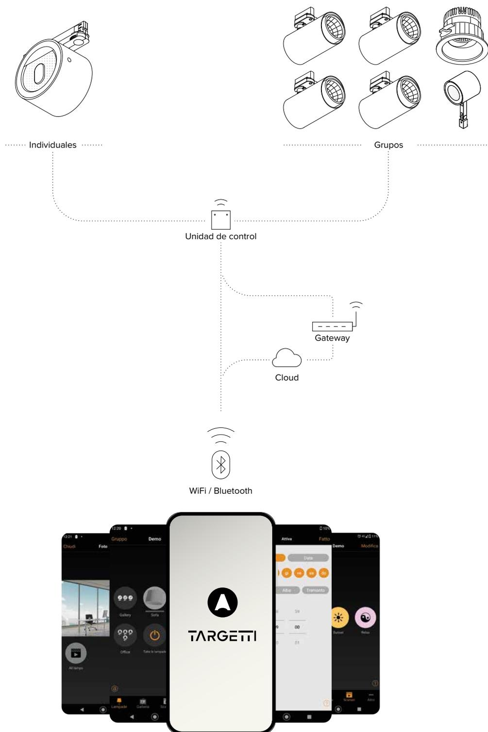
① Seleccionar entre las luminarias Targetti "Casambi on board" o con driver DALI, que se puede equipar con la unidad de control inalámbrico como accesorio
