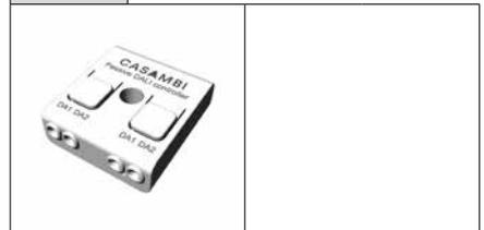
Bridge DALI/Casambi : dispositif qui permet d'interfacer des appareils dotés de la technologie mesh Bluetooth Casambi avec un système DALI classique et d'être pilotés par l'unité de commande DALI. À l'intérieur du circuit DALI habituel, on peut avoir jusqu'à 64 appareils DALI câblés et Casambi sans fils maximum. Fonctionne uniquement avec les réseaux Casambi Evolution.
